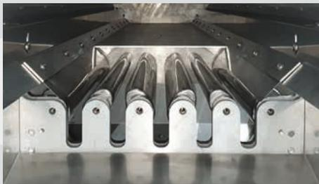
Über Handrad mit Digitalanzeige einstellbare Siebweite für unterschiedliche Artikelabmessungen.
