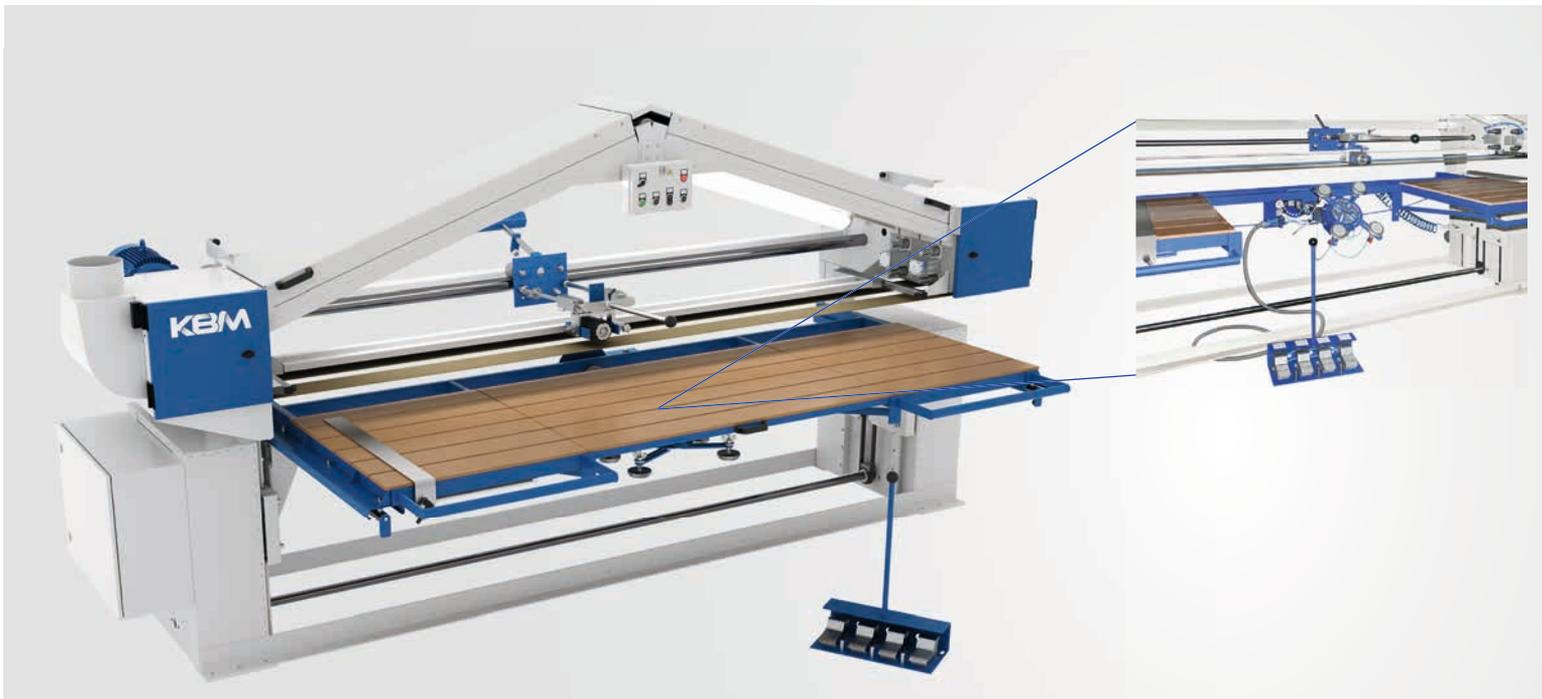
Die Handlingsvorrichtung ist in der Tischmitte unter dem Einlegerahmen montiert. Die Entriegelung der Dreh- und Schwenkachsen erfolgt pneumatisch über Fußschalter, das Bewegen der Drehachsen manuell.
