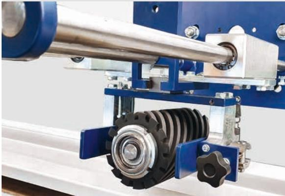
Schleif-Aggregat mit Schnellwechsel-System für Kontaktrollen und Schleifschuhe.
