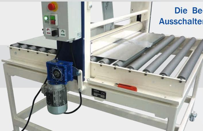
Die Bedienung erfolgt über eine einfaches Pult mit Ein-, Ausschalter und einem Not-Halt-Taster sowie einem Drehschalter für den Tipp-Betrieb des Beschichtvorgangs.
